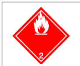
Label 2.1: flammable gas.
